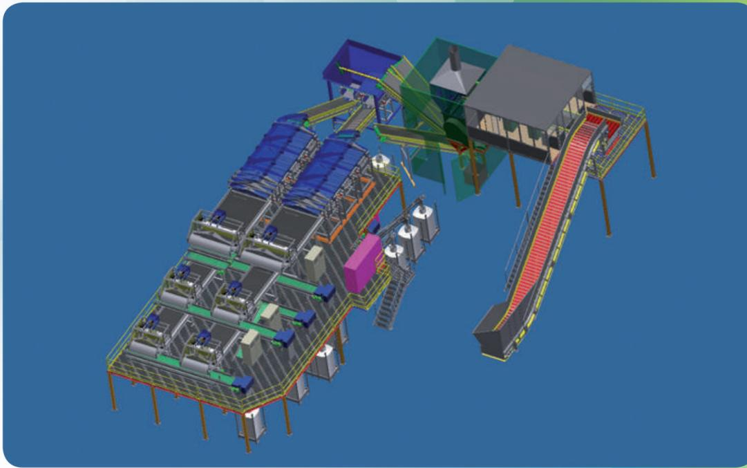
Esempio di inserimento selezionatrici ottiche in impianto per la valorizzazione delle plastiche (plastiche: ABS, PS, PA, PBT, PC, PE, PP, PET, PVC, PMMA, PUR, POM, plastiche miste PC+ABS, PPE+SB, PVC+ABS, ABS+TBBPA, plastiche con ritardanti di fiamma ABS+TBBPAep, PS+TBBPA, PS+TBBPAep, schede elettroniche, metalli. produzioni da 0,5 a 8 t/h, macchine modulabili a richiesta in base al materiale da trattare.
